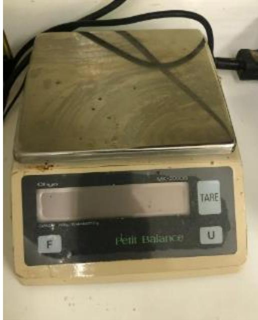
Figura 1. BALANZA DE PRECISION
