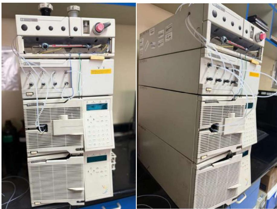
Figura 01. VISTA FRONTAL Y LATERAL DE CROMATOGRÁFO LÍQUIDO (HPLC)
