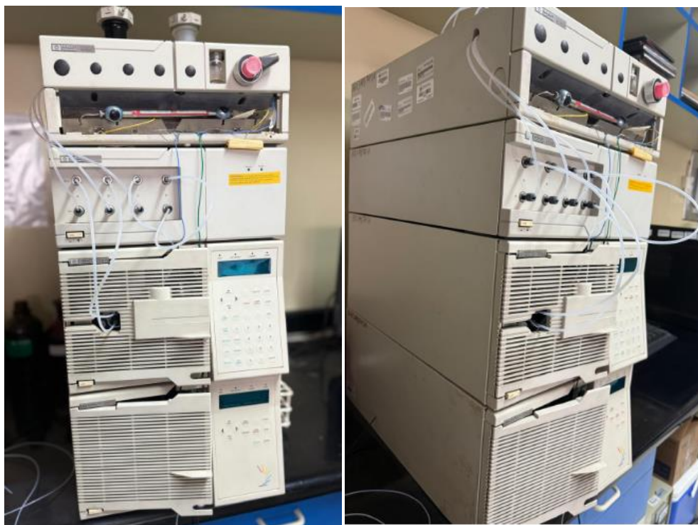
Figura 01. VISTA FRONTAL Y LATERAL DE CROMATOGRAFO LÍQUIDO (HPLC)
